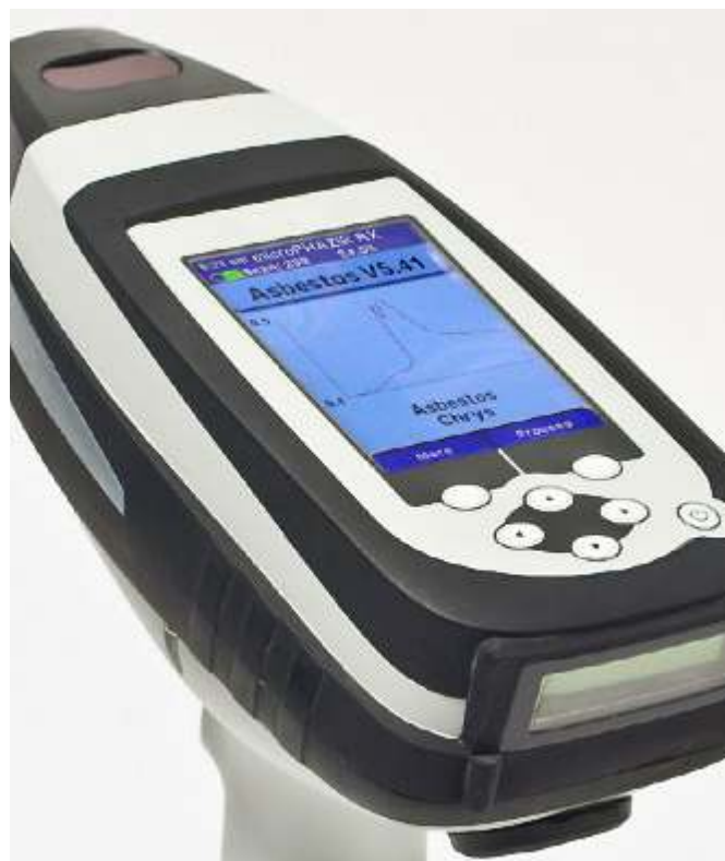
De handheld Asbestos analyzer is gebaseerd op NIR-spectrometrie.
